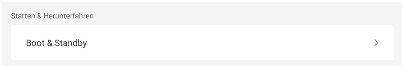
Unter „Boot & Standby“ verwalten Sie das Verhalten beim Start und bei (Nicht-)Benutzung des Displays. Durch Antippen dieser Schaltfläche erhalten Sie verschiedene Einstellmöglichkeiten.
